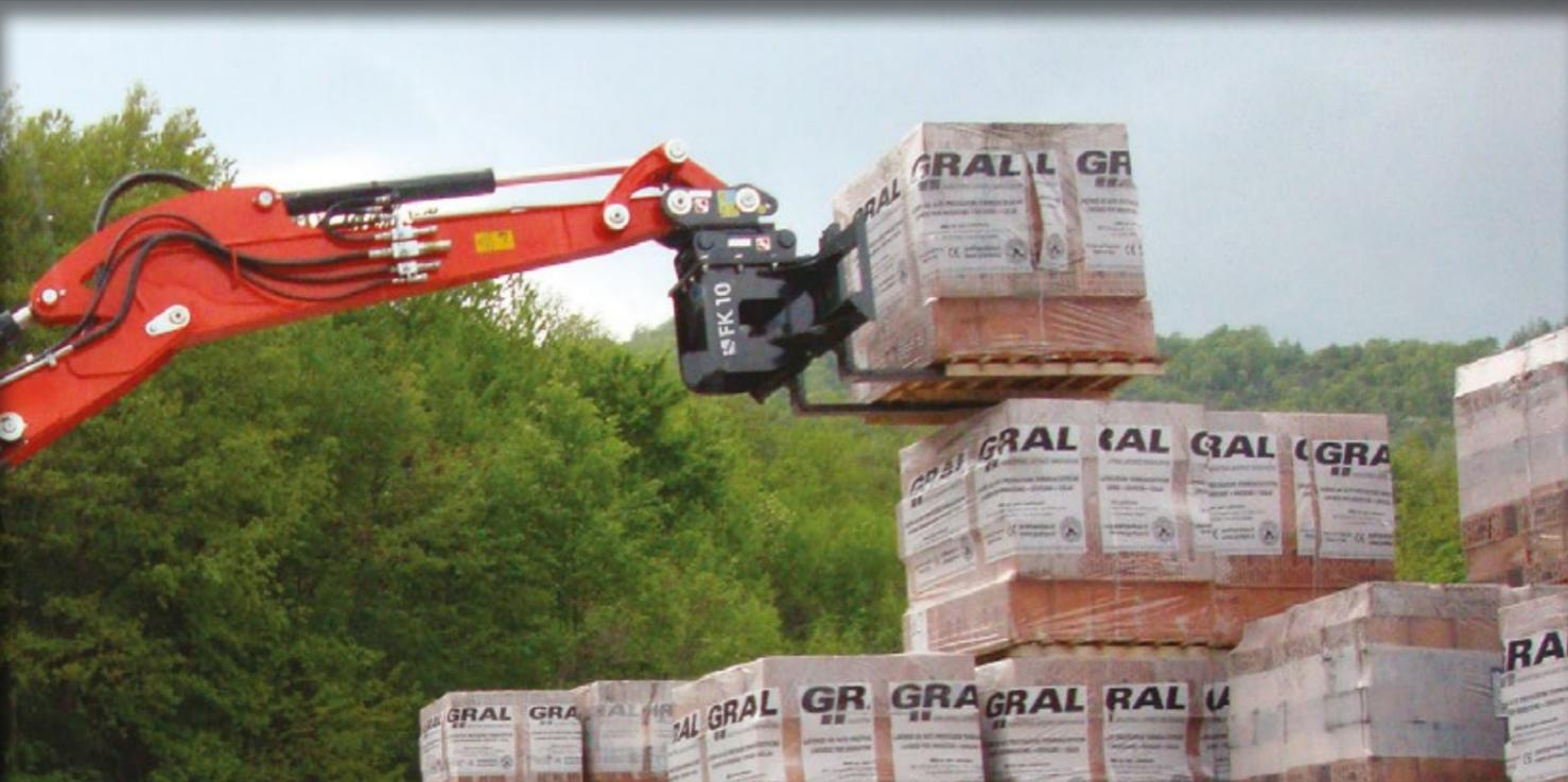
ESTA CONFIGURACIÓN ES COMPATIBLE CON LAS EXCAVADORAS PARA LA MANIPULACIÓN DE CARGAS EN ZONAS DE DIFÍCIL ACCESO CON OTROS MEDIOS. ES NECESARIO COMPROBAR DE TODOS MODOS QUE LA EXCAVADORA SEA APTA PARA LA ELEVACIÓN DE CONFORMIDAD CON LA DIRECTIVA MÁQUINAS.
