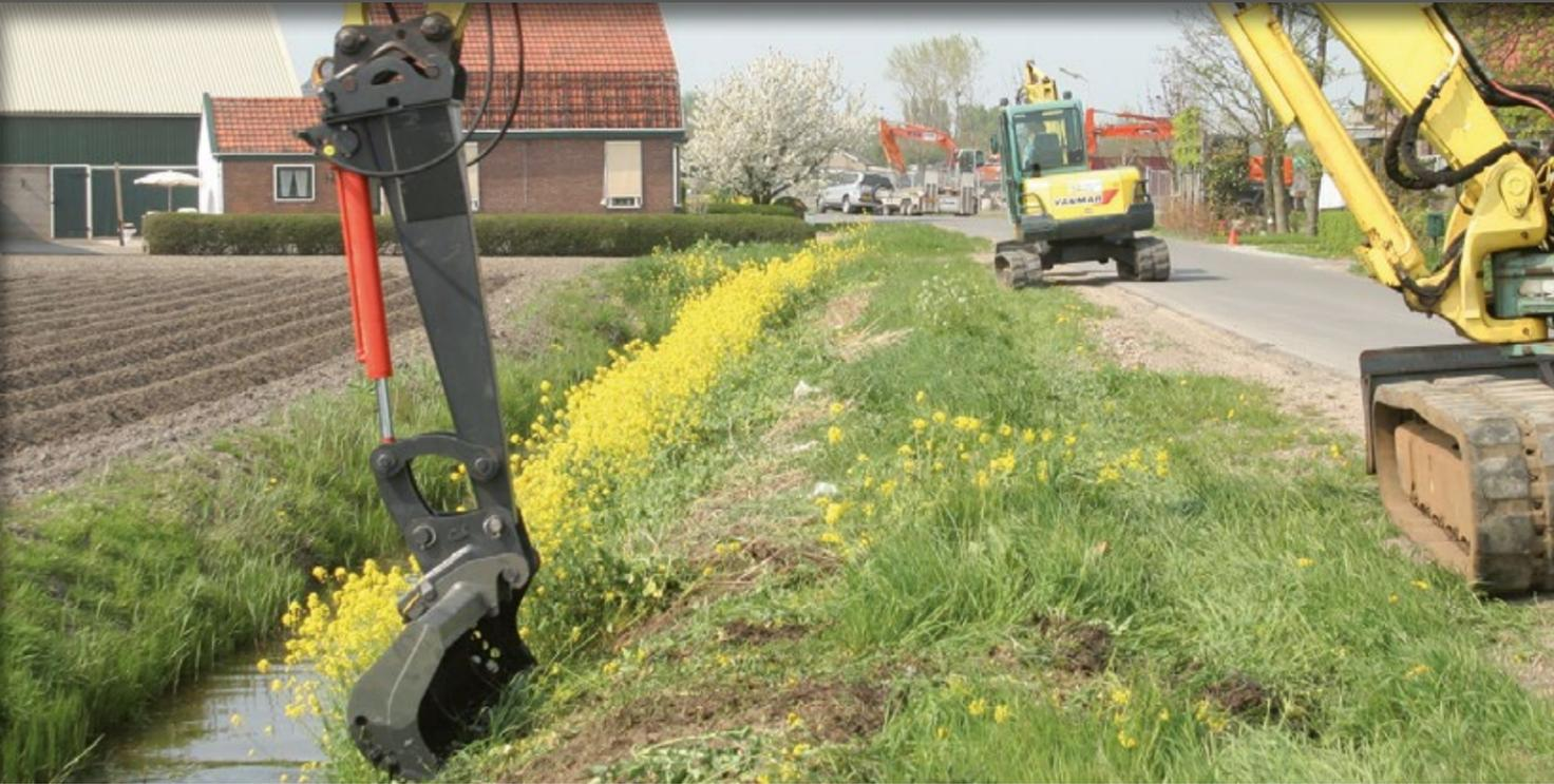
ESPECÍFICO PARA LAS OPERACIONES QUE REQUIEREN UN MAYOR RADIO DE ACCIÓN QUE EL DE LA CONFIGURACIÓN ESTÁNDAR DE LA MÁQUINA. EL BRAZO DE PROLONGACIÓN SE ENTREGA COMO "CUASI MÁQUINA" EN VIRTUD DEL ANEXO II-B DE LA DIRECTIVA MÁQUINAS 2006/42/CE. UNA VEZ INSTALADO EN LA MÁQUINA, DEBERÁ DECLARARSE SU CONFORMIDAD CE ANTES DE PONERLO EN SERVICIO.
