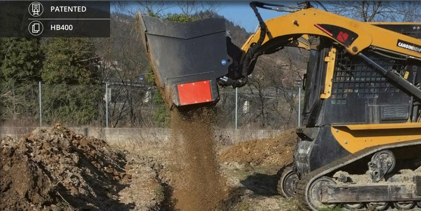
SE UTILIZA PARA LA SELECCIÓN DE ESCOMBROS DE DEMOLICIÓN, EXCAVACIONES Y MOVIMIENTO DE TIERRAS EN GENERAL. TAMBIÉN ES ÚTIL PARA LA MEZCLA DE TERRENOS CON TURBA. EL CRIBADO SE REALIZA MEDIANTE UNA CRIBA HIDRÁULICA CON CUCHILLAS GIRATORIAS EN HB400. EL ESPESOR DEL MATERIAL CRIBADO PUEDE VARIAR DE 0-20 MM A 0-35 MM EN LA CONFIGURACIÓN ESTÁNDAR.
