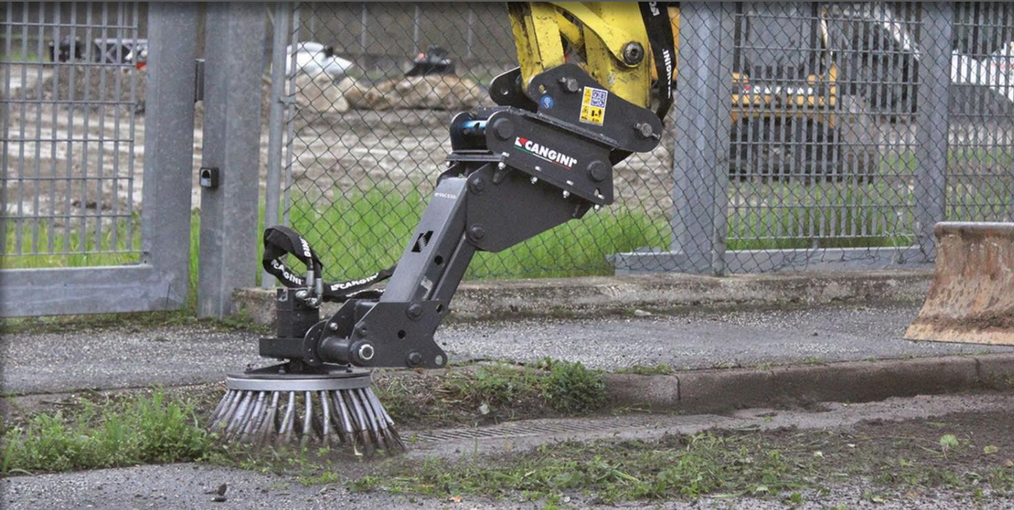
ESTE CEPILLO SE APLICA EN LA EXCAVADORA Y PRESENTA CERDAS DE ACERO, POR LO QUE ES IDEAL PARA LA ESCARDA DE BORDILLOS, ACERAS, BANQUINAS, ASFALTO, ETC. EL SISTEMA FLOTANTE Y LA ARTICULACIÓN DEL CABEZAL INCLUIDOS EN EL EQUIPAMIENTO PERMITEN LA ADAPTACIÓN DEL CEPILLO A LAS SUPERFICIES. LOS DOS SISTEMAS DE ARTICULACIÓN PUEDEN BLOQUEARSE EN UNA POSICIÓN DETERMINADA SEGÚN LAS NECESIDADES DEL USUARIO. EL CEPILLO DE PPL PERMITE BARRER SUPERFICIES DELICADAS DONDE NO SE REQUIERA LA OPERACIÓN DE ESCARDA.
