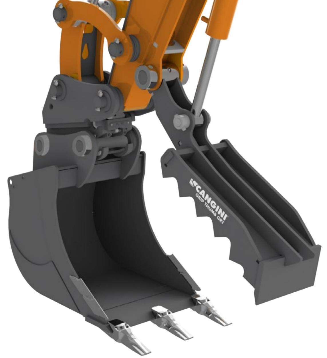
SOLDADO EN EL BRAZO, EL PULGAR GRT CANGINI FUNCIONA COMO UNA PINZA QUE FACILITA EL AGARRE DE MATERIAL ROCOSO, TRONCOS Y MUCHOS OTROS MATERIALES. UNA VEZ PLEGADO POR COMPLETO, PERMITE EL FUNCIONAMIENTO NORMAL DEL CAZO FACILITANDO EL TRABAJO DEL OPERADOR. AL MOMENTO DE PEDIRLO ES NECESARIO COMPROBAR LA FACTIBILIDAD DE LA APLICACIÓN PARA EVITAR FALLOS DE LA HERRAMIENTA.
